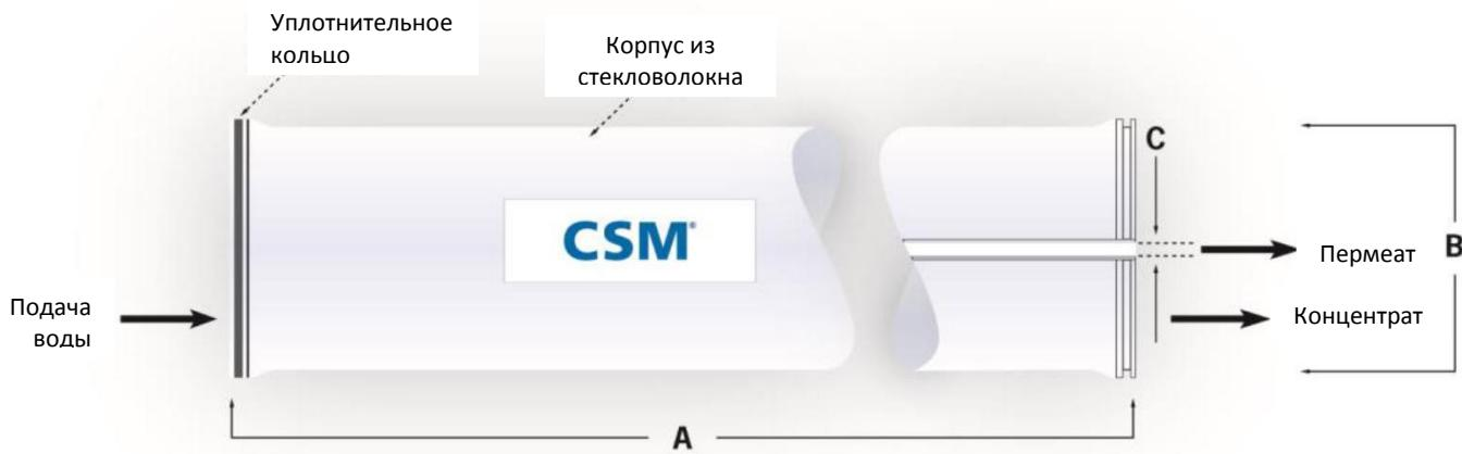
1. Каждый мембранный элемент поставляется в комплекте с одним уплотнительным кольцом, одним пермеатным адаптером и четырьмя прокладками типа O-ring.
