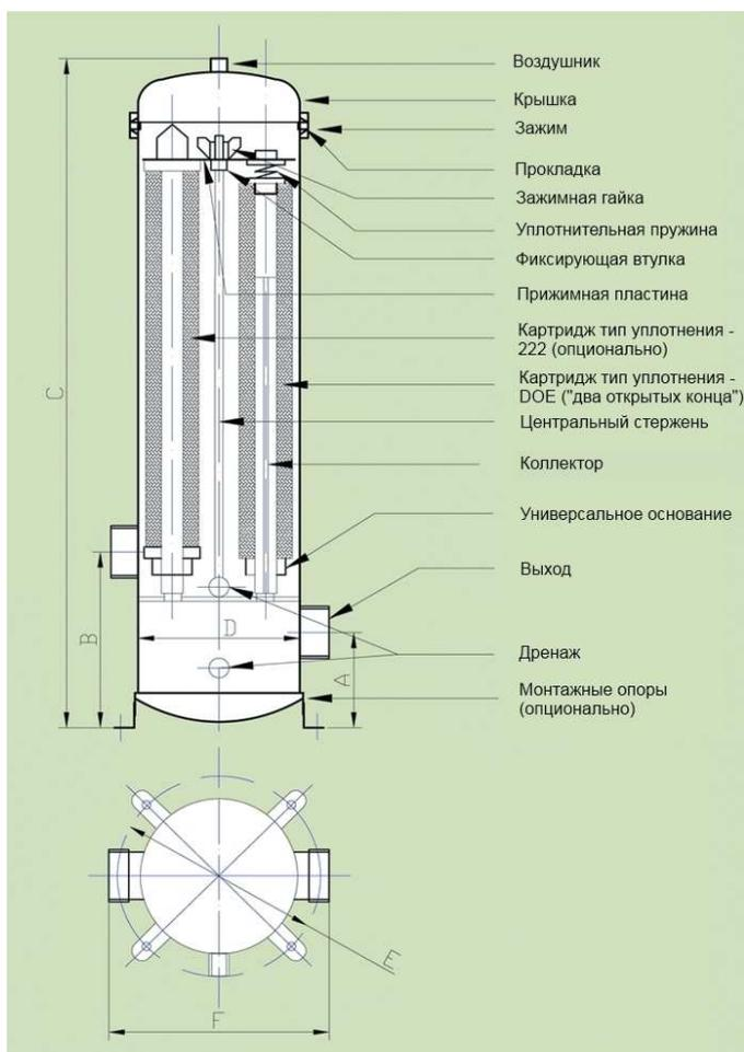
Во время работы фильтра вода поступает через входной патрубок и распределяется в корпусе между картриджами. Проходя через фильтрующий элемент (картридж) снаружи вовнутрь, вода очищается от мельчайших примесей. Отфильтрованная вода попадает через отверстия вовнутрь коллекторов, на которые надеты картриджи, опускается по ним в полость между дном и перегородкой и затем выводится через выходной патрубок.
