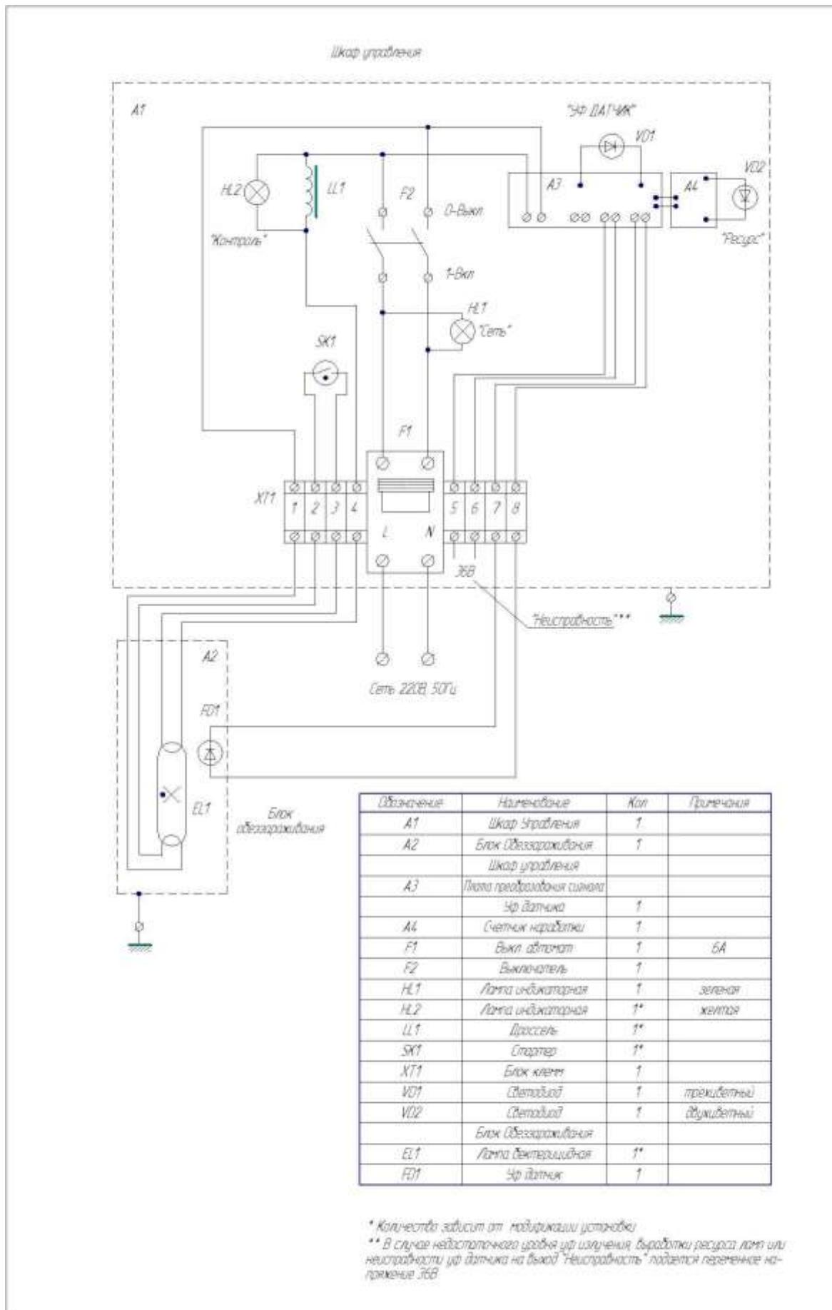
15.6. К установкам типа ОДВ-30, ОДВ-40, ОДВ-50, ОДВ-70, ОДВ-100, ОДВ-130, ОДВ-150, ОДВ-12С, ОДВ-16С, ОДВ-20С, ОДВ-30С, ОДВ-40С, ОДВ-50С, ОДВ-60С. Питание УФ ламп – ЭПРА.
