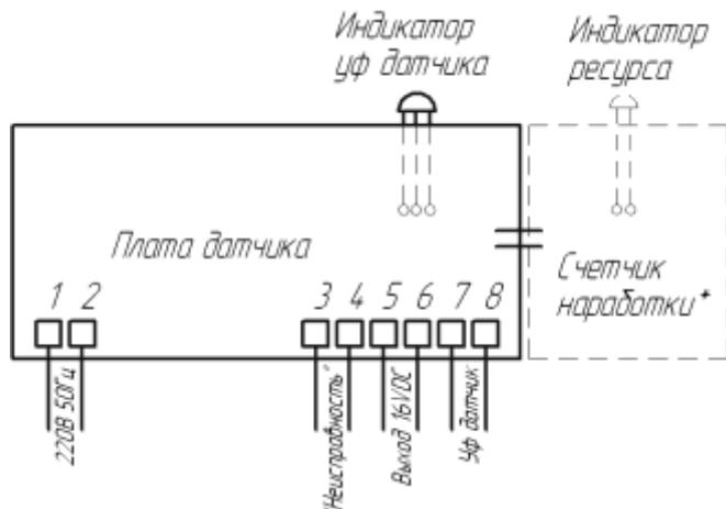
\*Счетчик наработки устанавливается в зависимости от модификации платы.
