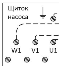
Рисунок 3. Схема электрического щитка моделей CROS 24 и CROS 36
