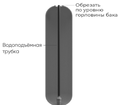
Обрезка водоподъемной трубы
