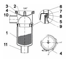
Во время работы фильтра вода поступает через входной патрубок *10* и, проходя через фильтрующий элемент, очищается от мельчайших примесей. Отфильтрованная вода выводится вниз через выходной *11* патрубок.
