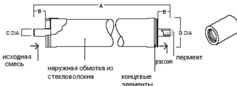
К каждому элементу FILMTEC прилагается муфта №89055. каждая муфта имеет по 2 кольцевых уплотнения 2-210 EPR(FilmTec № 89255)
